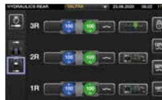
Vous pouvez affecter n'importe quelle commande pour actionner n'importe quelle fonction hydraulique, y compris les distributeurs hydrauliques avant et arrière et le chargeur avant.
