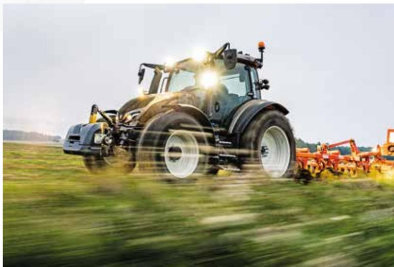
En tant que motoriste, tractoriste et avec 70 ans d'expérience, les moteurs compacts AgcoPower offrent une grande puissance et un couple élevé. Le moteur compact de 4,4 l avec de petites dimensions permet un capot plongeant avec une grande visibilité. Le système post-traitement du moteur tout-en-un nettoie l'échappement
